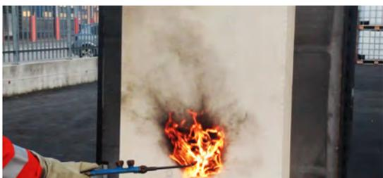
◀ **Contacto del núcleo de espuma PIR con la llama.**
