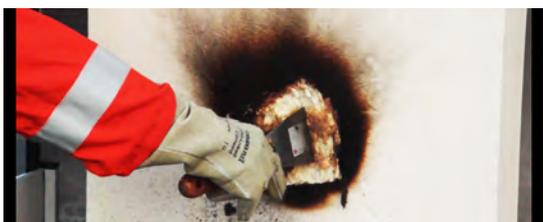
◀ **la carbonización del estrato de espuma en contacto con el fuego, impide al fuego de propagarse.**
